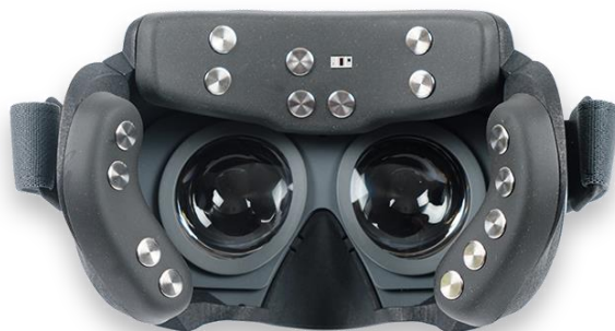
Figure 1 : Un casque de réalité virtuelle équipé des capteurs de myographie EmteqPro
