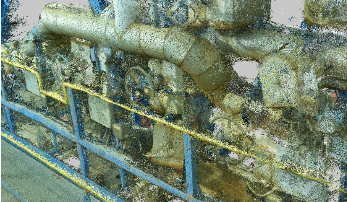
Figure 2 Exemple d'un nuage de point de site industriel
