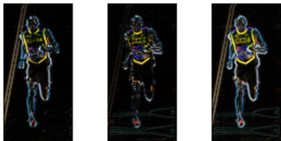
Left : Absolute value of x-gradient. Center : Absolute value of y-gradient. Right : Magnitude of gradient.
