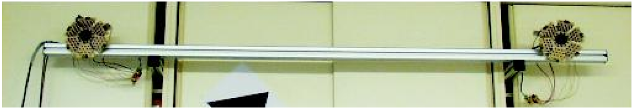
FIGURE 3 – Monture avec les deux caméras infrarouge [7]
